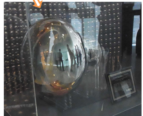
スーパーカミオカンデの 光電子増倍管 直径50cm
